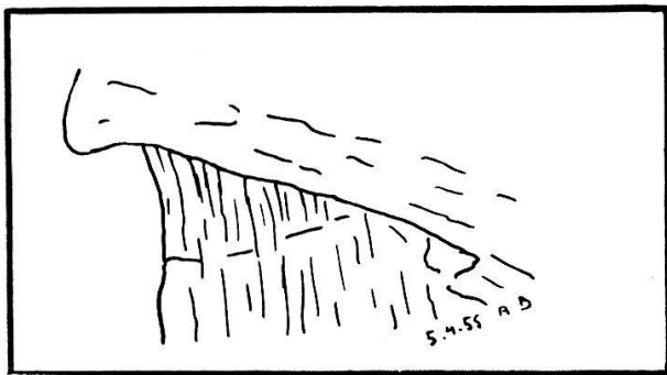
Fig. 9. Discordance entre les gneiss (dessous, N 60 E, verticaux) et la cornieule (dessus, N 110 E ; 30° S). Longueur de l'affleurement 1 m. E de Feschel.
