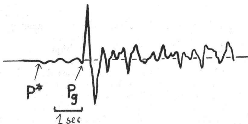
FIG. 3. — Agrandissement d'une partie de l'enregistrement, par un séismographe de Zurich, de la composante verticale de la réplique du 24 février 1946.
