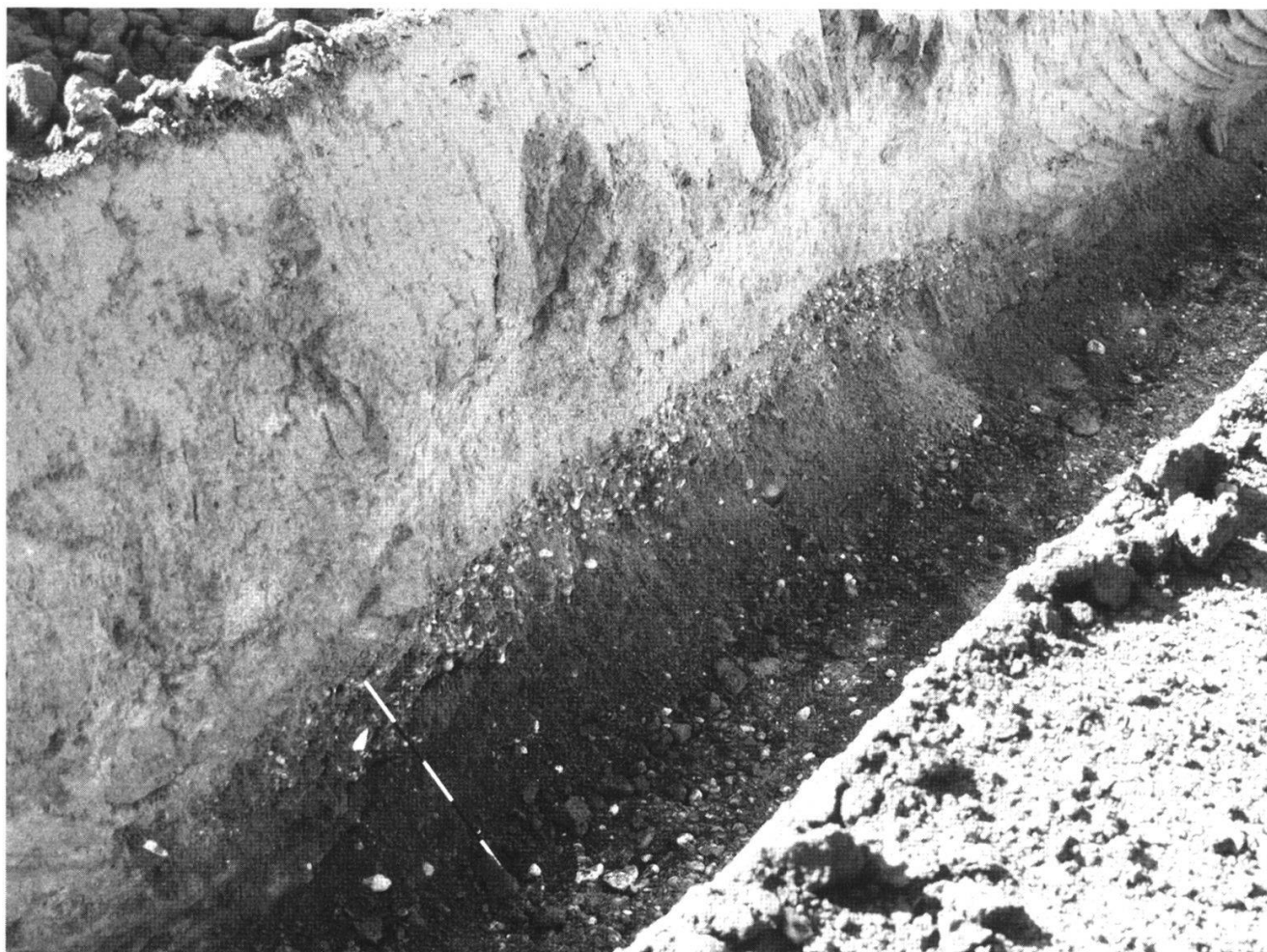
Figure 12.—Coupe de route dans la tranchée de la conduite de chauffage à distance, à l'emplacement de l'anomalie du profil ECL2. L'E est à gauche de l'image. Graduations du jalon: 10 cm (photo P. Gex).
