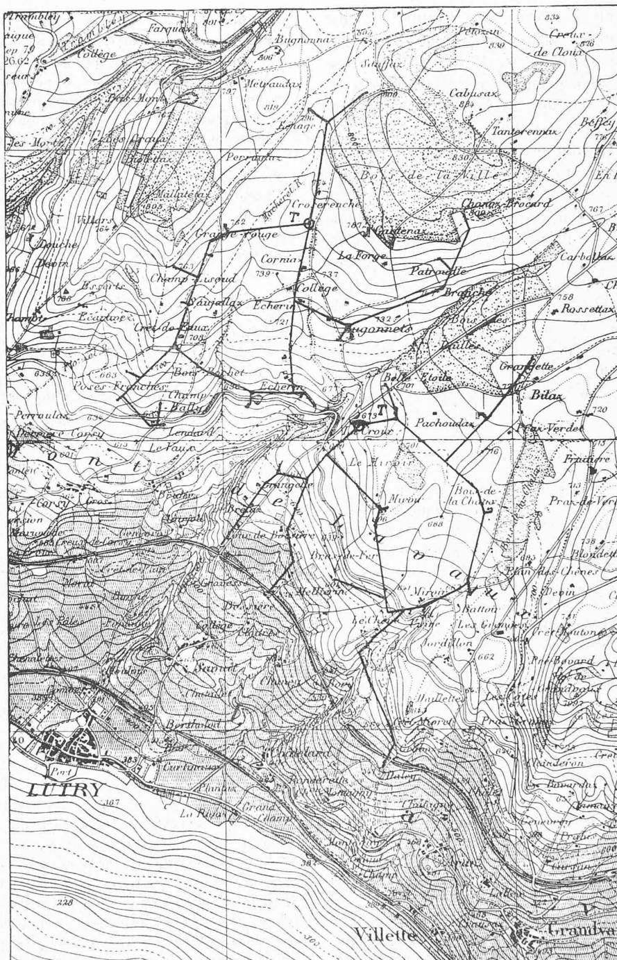
Réseau électrique en aluminium sur les Monts de Lutrzy. — Echelle 1 : 25000. (Reproduit avec l'autorisation (7-II-17) du Service topographique fédéral.)
