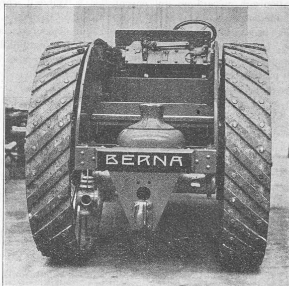
Fig. 4. — Tracteur Berna, avec roues munies de crampons plats.
