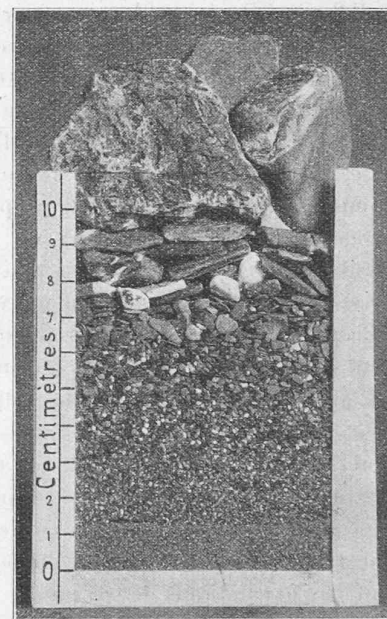
Fig. 34. — Alluvions éliminées, prélevées dans l'eau de purge du dessableur.
