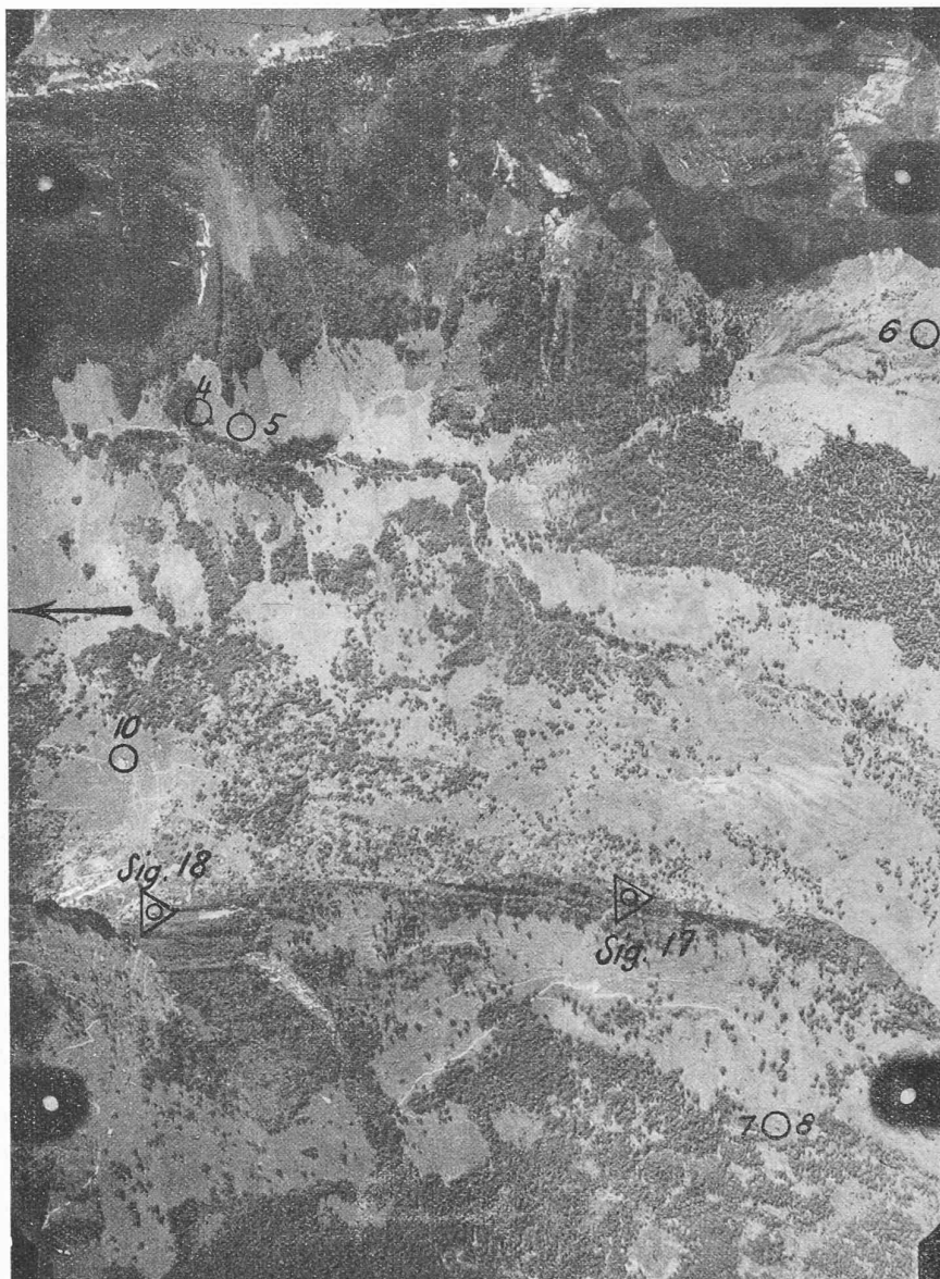
Fig. 4. — Levé stéréophotogrammétrique, par avion, du cadastre de Bilten-Niederurnen. Vue verticale convergente. Altitude de l'avion au-dessus du sol, 2600-3200 mètres. Longueur de la base, 2559,20 mètres.
