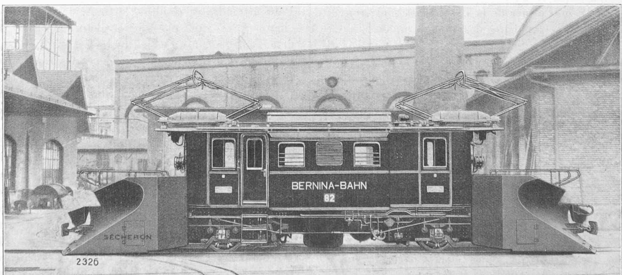
Fig. 1. — Locomotive à courant continu, type AA-AA N° 82, du chemin de fer de la Bernina.
