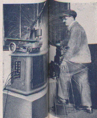
Soudeuse type 2 S. B. F. en bout par "projection" de tubes de diamètre intérieur.
