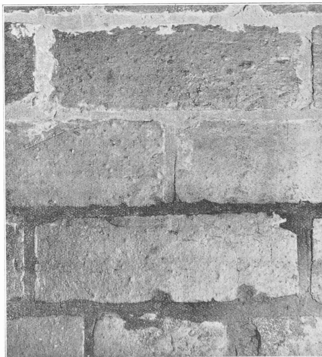
Fig. 8. — Surface de briques du Staffordshire, après 1800 jours d'immersion.
