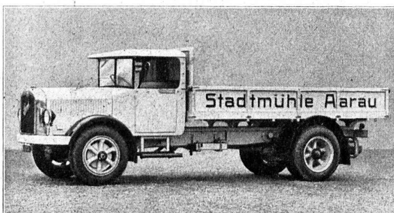
Camion 5 T. Type 5 BLD avec moteur « Diesel » 6 cyl.
