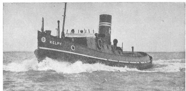
Fig. 1. — Remorqueur anglais, de 300 ch. muni d'un inverseur de marche type « S. L. M. — Winterthur. »
