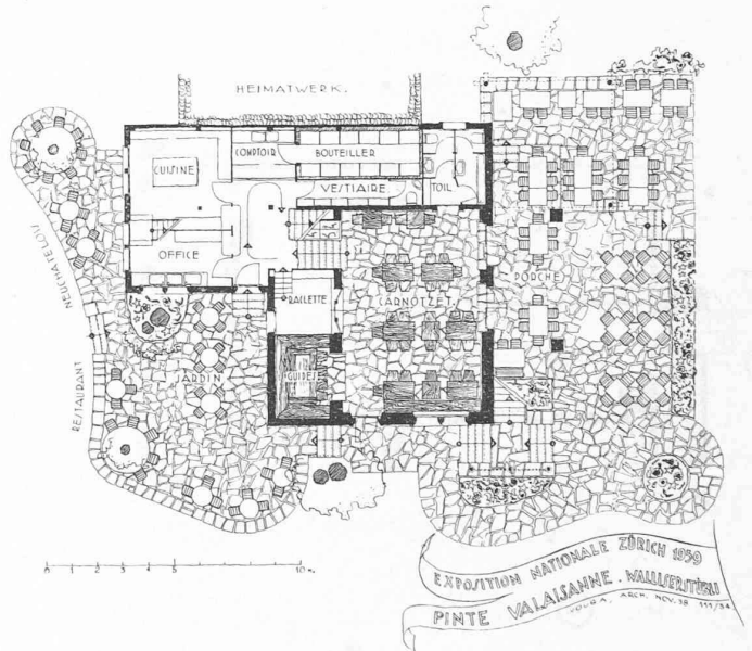
Fig. 19. — La « Pinte valaisanne ». Plan du rez-de-chaussée. Echelle 1 : 300.
