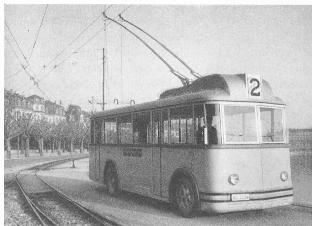
Fig. 1. — Voiture rentrant au dépôt, ligne aérienne avec croisement tramway-trolleybus.
