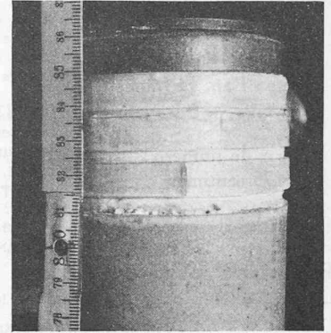
Fig. 3. — Essai sur poudre de quartz placée dans un cylindre composé d'anneaux superposés de 1 cm de hauteur. Noter la fissure. Epaisseur initiale 3 cm, finale ~ 4 cm
