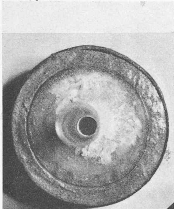
Fig. 20. — Discontinuité obtenue dans une suspension de bentonite contenant du sable grossier.
