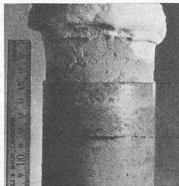
Fig. 2. — Gonflement obtenu au Laboratoire de Lausanne, sur échantillon dit « Pierre morte » placé dans un cylindre transparent.
