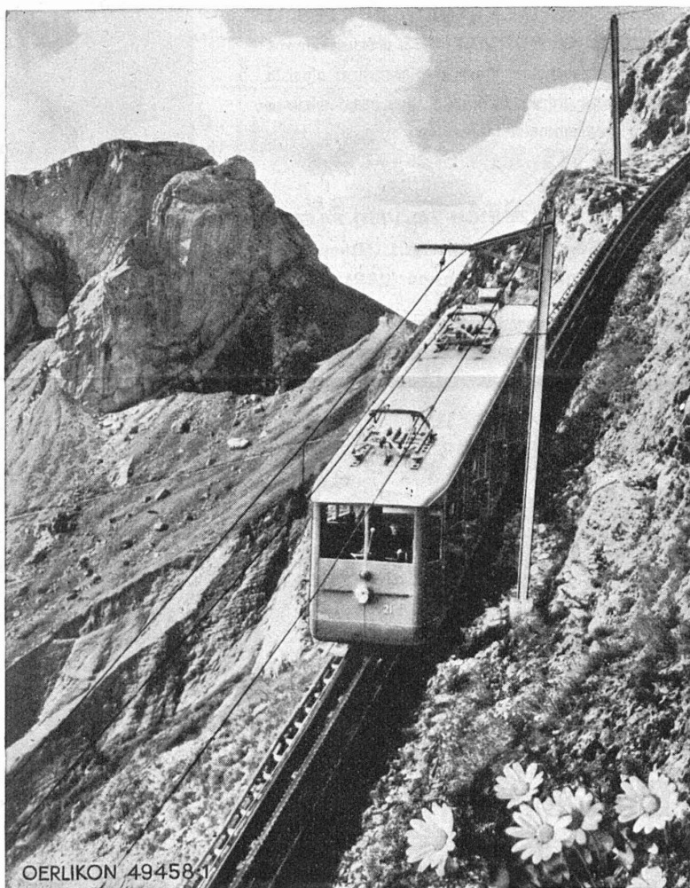
Chemin de fer du Pilate, le chemin de fer à crémaillère avec rampe la plus forte du monde. Toutes les automotrices sont équipées par Oerlikon.
