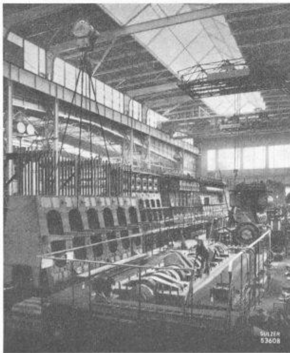
Fig. 12. — Halle de montage pour grands moteurs Diesel dans les usines de Sulzer Frères S. A., Winterthour.
