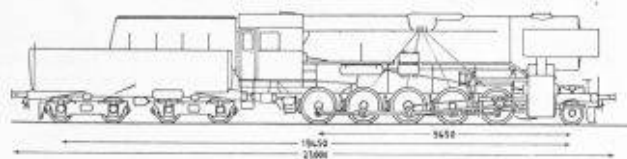
Fig. 1. — La locomotive « de guerre » lourde allemande, série 42. Diagramme.
