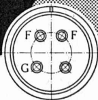
Culot des types TQ 2/3 et TQ 2/6 vus de dessous
