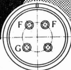
Culot des types TQ 2/3 et TQ 2/6 vu de dessous
