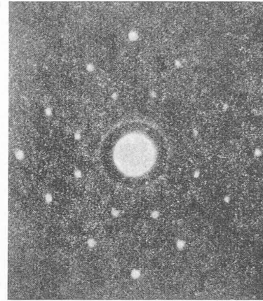
Fig. 7. — Diagramme de Laue obtenu par diffraction d'un faisceau de neutrons du réacteur d'Oak-Ridge sur un monocristal de NaCl. Il s'agit là d'un phénomène et d'une méthode d'analyse cristalline courants pour les rayons X. L'emploi des neutrons permet des indications supplémentaires très précieuses et inaccessibles par les autres procédés (en particulier la localisation des atomes H, la détermination d'anisotropies de nature magnétique et l'estimation de la force de certaines liaisons intermoléculaires) et tend à prendre une grande importance comme méthode d'étude de la structure des solides et des liquides.
