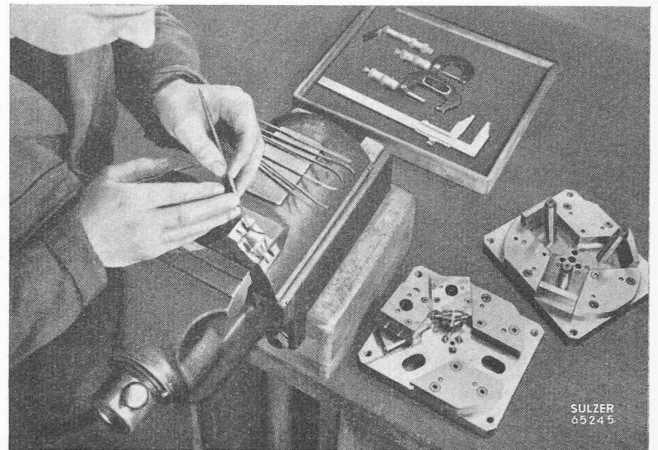
Fig. 2. — Fabrication d'une coquille en acier.
