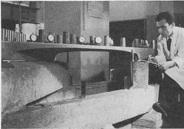
Fig. 16. — Pont d'Aigle. Modèle réduit chargé.
