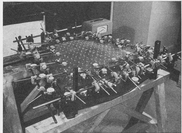
Fig. 18. — Aula de l'Ecole supérieure de jeunes filles. Modèle réduit chargé.
