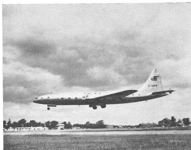
Le Brabazon , tentative hardie entre toutes : quatre hélices coaxiales contrarotatives absorbent la puissance de quatre groupes de turbopropulseurs Proteus jumelé de 6400 ch par groupe (à l'arrêt, altitude 0 m, plus 715 kg de poussée), logés dans l'aile (soit 25.600 ch ) ( \varnothing hélice = 4,88 m).
