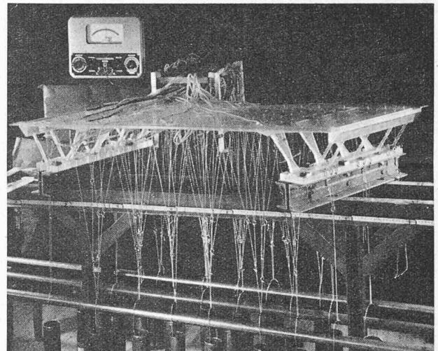
Fig. 2. — Essai sur modèle réduit, en plexiglas, d'un pont biais avec appuis triangulés. Echelle du modèle 1 : 50.
