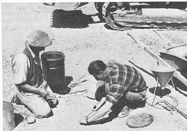
Photo n° 9. — Détermination de la densité sur place.
