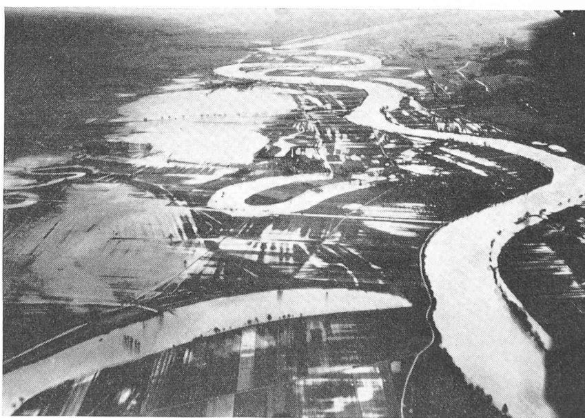
(Service photographique des Troupes d'aviation) Fig. 5. — Vue aérienne de la plaine de l'Aar entre Büren et Soleure, a en novembre 1944. Débit de l'Aar à Nidau : 700 m 3 /sec.
