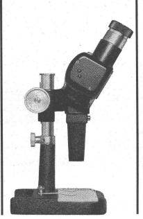
Microscope stéréoscopique Kern, l'instrument de contrôle et de mesure à multiples usages dans toutes les branches d'industrie.
