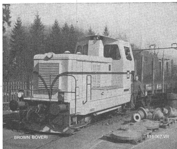
Locomotive diesel-électrique industrielle, 330 ch, pour le service de manœuvre de trains jusqu'à une charge au crochet de 1000 t.
