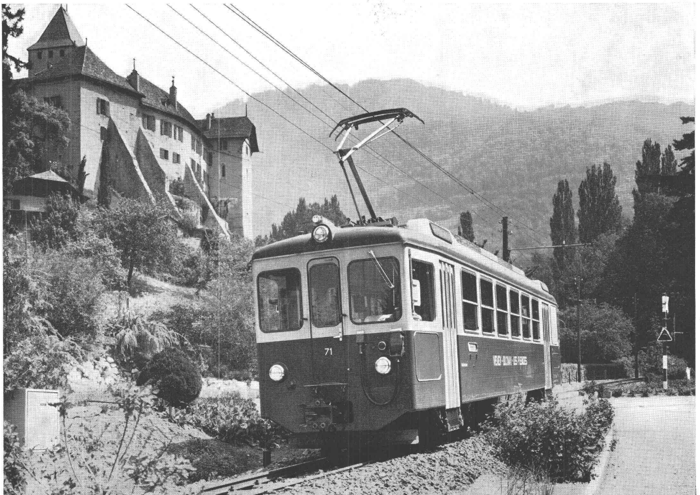
Nouvelle automotrice à crémaillère et adhérence de 568 ch, type BDeh 2/4, à voie métrique des Chemins de Fer Electriques Veveysans (CEV) dont l'équipement électrique a été livré par la S.A. des Ateliers de Sécheron à Genève.
