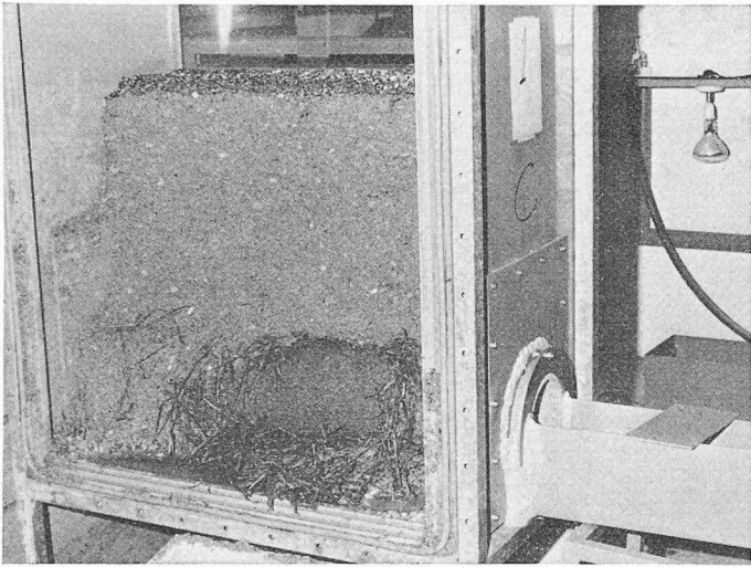
Fig. 3. — Tuyau enterré plus filtre-paille.
