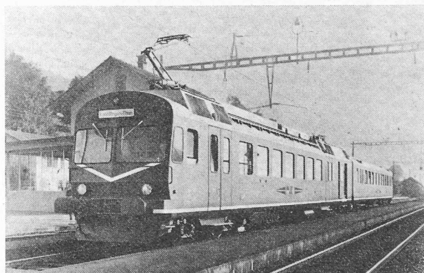
Fig. 33. — Rame automotrice Bo'Bo' de la série RBDe 4/4 de l'EBT.
