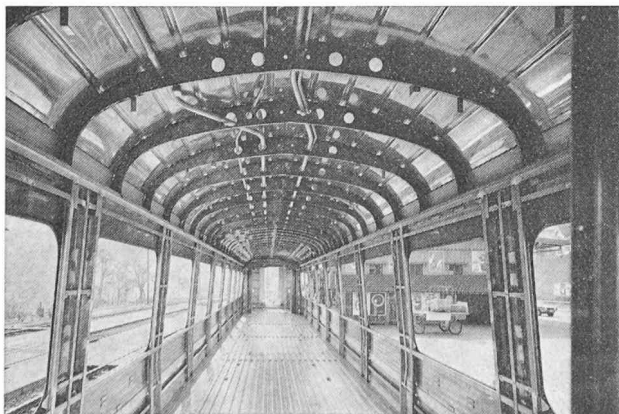
Fig. 143. — Intérieur du châssis-caisse nu. (Photo SIG)
