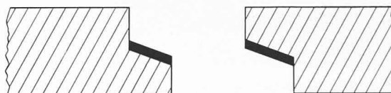
PHASE I : Application industrialisée de bandes « BFL-Mastix » sur les embouts mâle et femelle préchauffés, exécutée à pied d'œuvre de la fabrique. Pas de traitement préalable des embouts à l'enduit primer.
