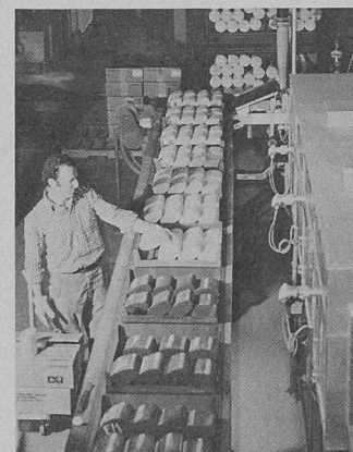
Vue partielle de l'installation de production de catalyseurs pour les gaz d'échappement des automobiles dans l'usine de la Degussa à Rheinfelden. L'installation a une capacité d'environ 1 million de catalyseurs par an.
