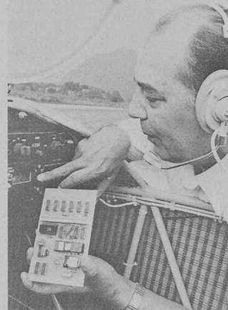
L'amateurisme en micro-électronique a abouti dans ce cas à un résultat digne d'un professionnel. Sur le tableau de bord de ce petit avion à moteur se distingue un système de radionavigation VOR que M. Walter Preter (photo), du club de vol à voile de Siemens Munich a équipé d'un micro-ordinateur. Un afficheur numérique à cristaux liquides monté sous cet appareil calcule en permanence le cap compas jusqu'à la prochaine balise. Le micro-ordinateur est actuellement programmé sur toutes les fréquences de navigation des balises européennes; le pilote pourra donc se passer de nombreux ouvrages de référence indispensables jusqu'ici.
