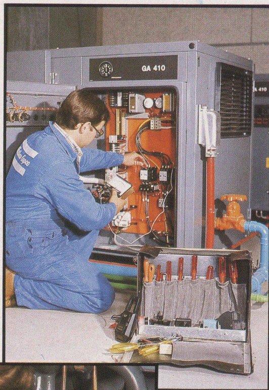
GA — 410 Oeleingespritzter Schraubenverdichter
