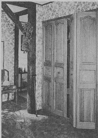
Quercy: fabrication en chêne, montants et traverses à moulures petit cadre et panneaux à plate-bande. La traverse supérieure est en forme de chapeau de gendarme. Elles s'intègrent dans des intérieurs de style traditionnel, ancien ou rustique, en apportant la chaleur du bois.
