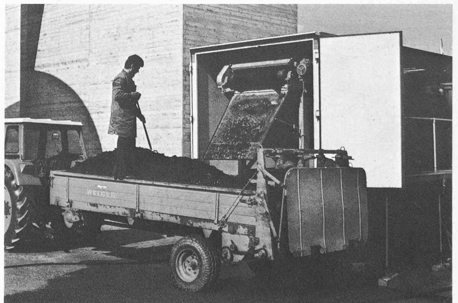
Fig. 1. — Epandeuse à boues déshydratées assimilables à du fumier.
