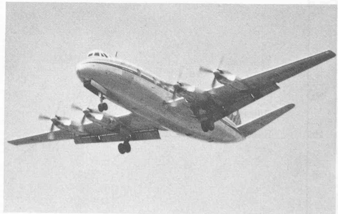
Fig. 5. — Danger de la conception Safe Life: un avion du type Vickers Viscount a été victime d'une rupture d'aile, à fin 1968. De légers défauts de fabrication d'un élément de longeron ont raccourci considérablement la durée de vie effective de cette pièce.
