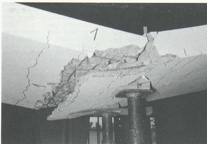
Fig. 9. — Rupture des dalles d'essai 1 et 5.
