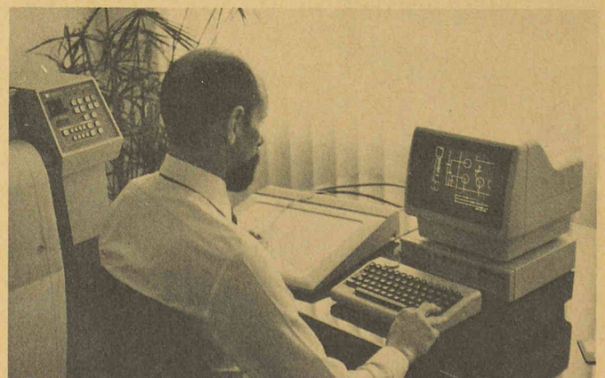
Unité centrale avec clavier, tablette graphique, puck et traceur de courbes.
