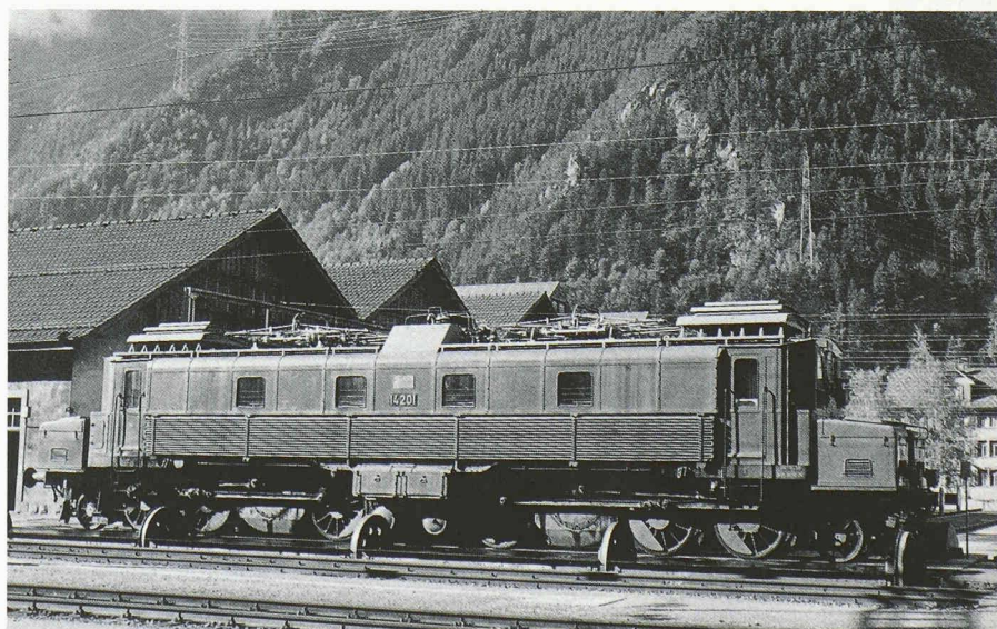
Fig. 5. — Un vétérans au repos devant le dépôt d'Ersfeld en 1981, Ce 6/8 11 14201. Cette locomotive livrée en 1920 est la seule survivante des quatre prototypes livrés en 1919 et 1920 aux CFF. Quelques caractéristiques : masse 99 t, vitesse maximale 65 km/h, puissance unihoraire 1750 kW à 41 km/h. Ce véhicule ne doit sa survie, en 1967 — à une époque où l'on ne s'intéressait pas encore assez à ces témoins pionniers de l'époque de l'électrification —, qu'au fait que la division de la traction et des ateliers avait besoin d'une locomotive pouvant exercer un effort de traction non négligeable pour les trains d'essais des freins. Après avoir circulé en tête de nombreux trains spéciaux quelques années comme locomotive historique habillée en brun, la couleur d'ordonnance des locomotives CFF jusqu'en 1927, la Ce 6/8 11 14201 est entrée en 1982 à la Maison suisse des Transports à Lucerne à l'occasion de l'inauguration de l'agrandissement des halles ferroviaires pour le centenaire de la ligne du Saint-Gothard. (Photo R. Schorno)
