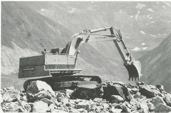
Les pelles hydrauliques 235 et 245 Cat ont travaillé à fort rendement pendant toute la durée des travaux — sur des sites quasiment inaccessibles et dans des conditions très difficiles.
