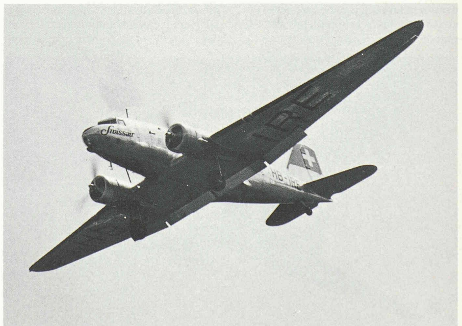
Un Douglas DC-3 de Swissair. Il s'agit là d'un avion acquis par notre compagnie nationale avant la guerre déjà, encore équipé de moteurs Wright Cyclone (9 cylindres en étoile) de 1000 ch, alors que les Dakota reconvertis en version civile (photo en fin d'article) avaient des Pratt & Whitney Twin Wasp (14 cylindres en double étoile) de 1200 ch. (Photo J.-P. Weibel.)
