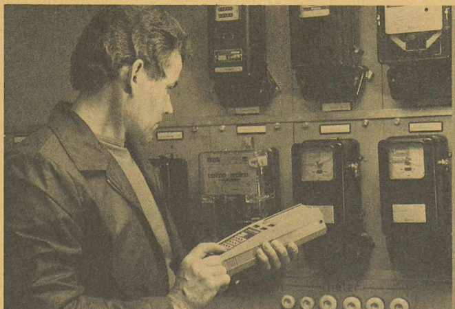
Dans le domaine de l'énergie, le terminal de données GRE3 Wild est très pratique pour faire le levé des compteurs. Jusqu'ici, les chiffres devaient être inscrits avec peine et grande perte de temps sur des bordereaux et recopiés ensuite. Il suffit maintenant de les introduire dans le GRE3 puis de les enregistrer automatiquement dans l'ordinateur.
