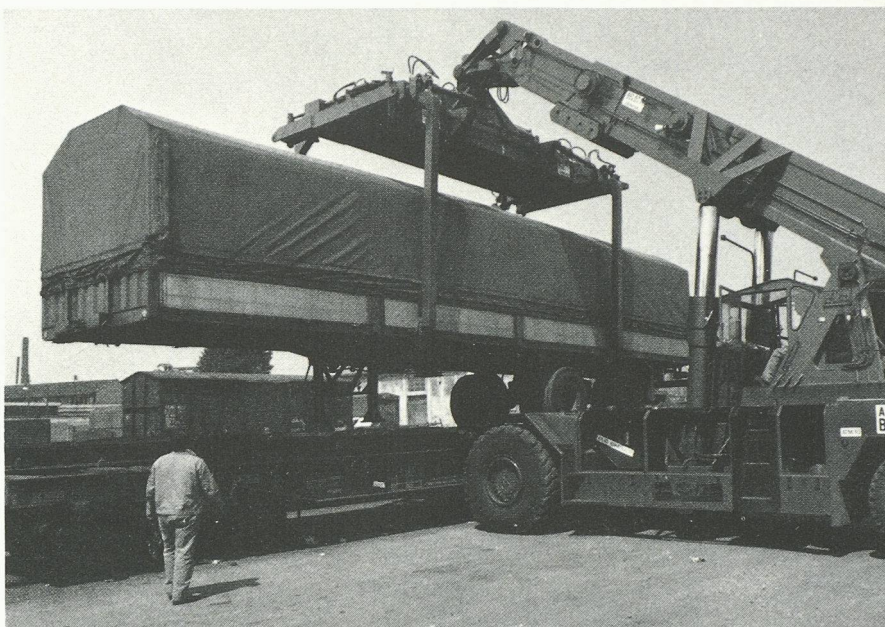
Chargement d'un semi-remorque sur un wagon à poche.
