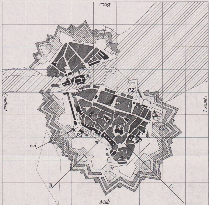
Fig. 11. - Le plan de Genève fortifiée selon des Roques et la Ramière, reporté sur la matrice type. A l'intérieur des fortifications, les modifications du port de Longemalle, de l'île et de la porte Neuve correspondent à l'état selon le plan Céard (1830). Les trois axes A, B et C indiquent encore le système défensif envers la Savoie. L'ensemble des quatre immeubles Beauregard (1774) est la dernière réalisation intra-muros au sud.
