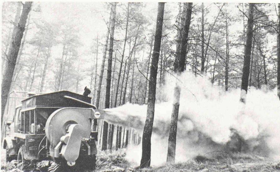
Chaulage de la forêt contre les sols acides. En vue d'endiguer le dépérissement des forêts, on a répandu mécaniquement du carbonate de chaux au magnésium enrichi de phosphates pour protéger les cultures forestières proches des grands centres industriels, par exemple dans la région de la Ruhr. (Photo : INP.)
