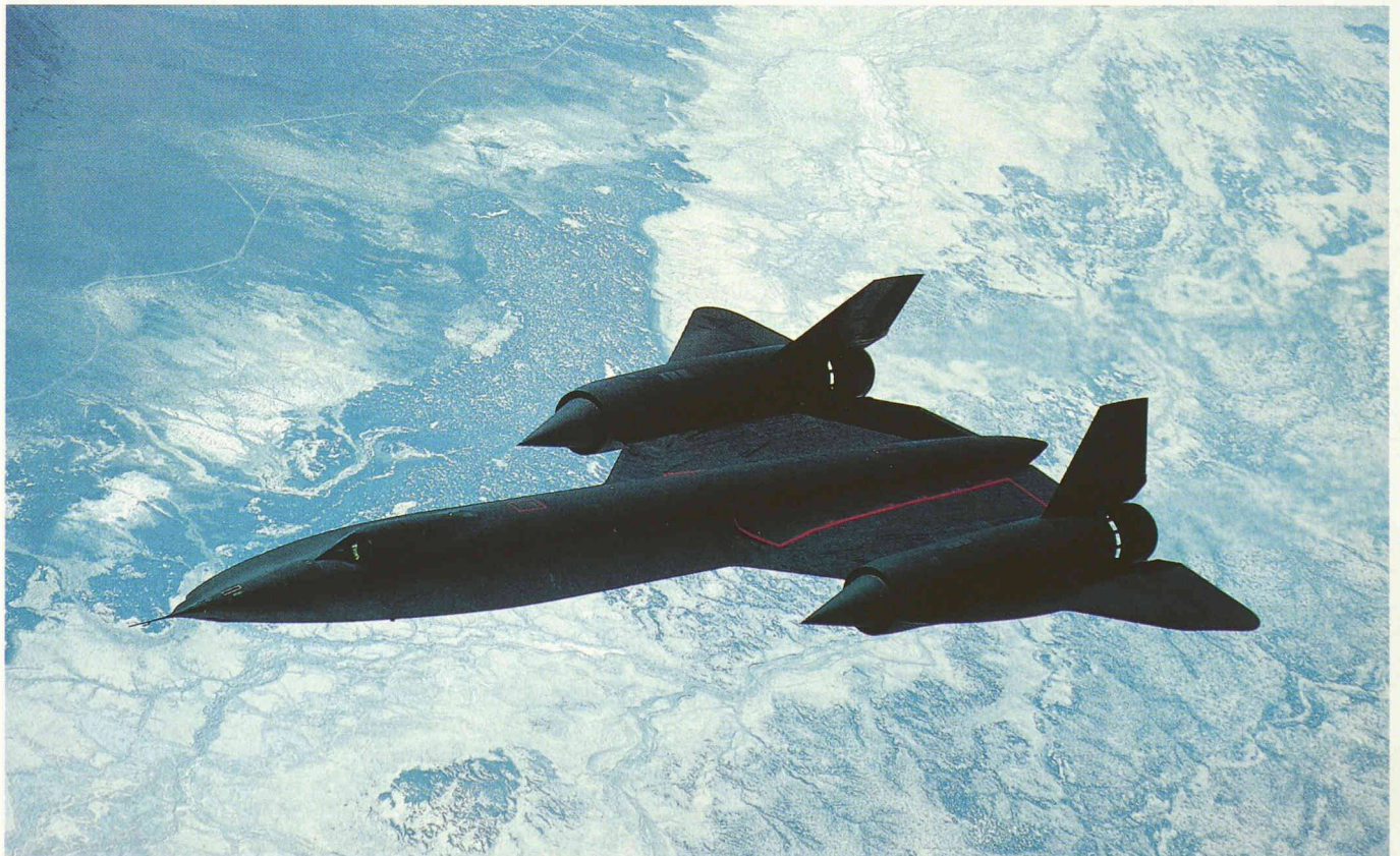
Le Lockheed SR-71A Blackbird en vol à haute altitude (le suffixe A désigne la version opérationnelle; le SR-71B est un avion d'entraînement à double commande, sans équipement de reconnaissance). Le rectangle entouré de rouge, derrière les postes de pilotage et du RSO, montre l'emplacement de la prise (fermée ici) pour le ravitaillement de carburant en vol. A l'arrière des réacteurs, on distingue les prises d'air supplémentaires ouvertes. (Photo USAF / Weibel.)
